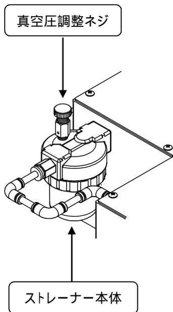
吸着パッドに果実、野菜を吸い付ける吸着力(真空圧)の調整が出来ます。
