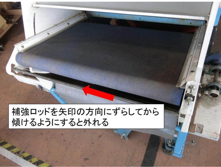
補強ロッドを矢印の方向にずらしてから傾けるようにすると外れる
