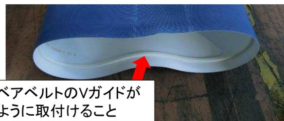
選別コンベアベルトのVガイドが下になるように取付けること
