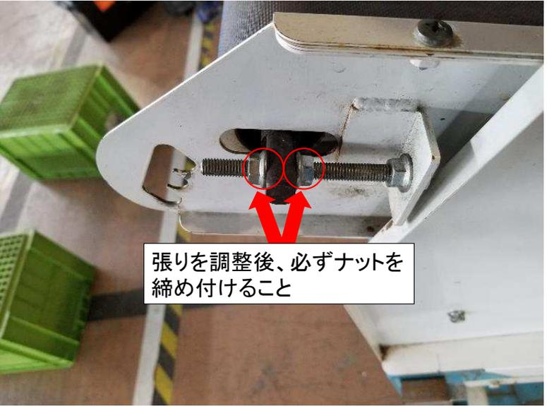
張りを調整後、必ずナットを締め付けること
