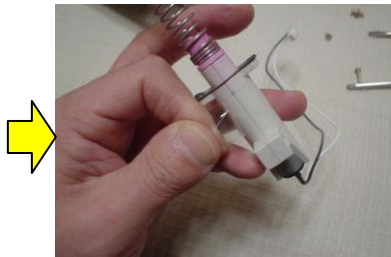
漏れ防止にビニールテープが貼ってある。
