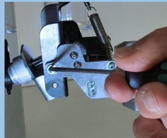
マイナスドライバーで、Eリングを片側だけ外します。
