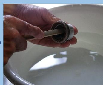
ブラシで汚れを落とした後、パッドホルダーを取り付けます(取り付ける際は、締めすぎに注意してください)。
