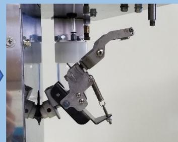
軸を取り付けて、再度 Rピンと、Eリングを取り付けます。
