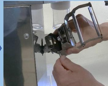
RピンとEリングが付いていた軸を抜いて、アームを外します。
